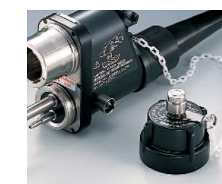
Водонепроницаемый колпачок присоединён к коннектору видеоскопа
