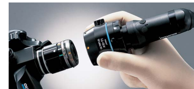
Видеоконвертер OVC-70 присоединяется к различным эндоскопам через стандартные видеоадаптеры.
