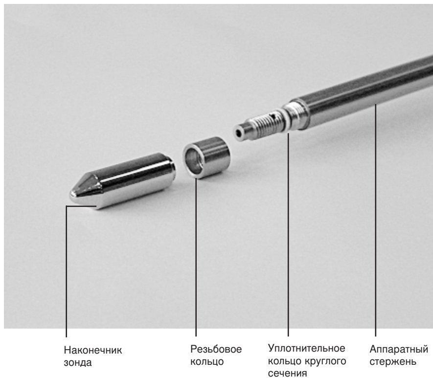
Рис.5. Аппаратный стержень с открученным наконечником зонда. При снятом резьбовом кольце видно уплотнительное кольцо круглого сечения
